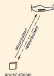
Fig. 11. Bij een transponder gaan de stuurpulsen uit van het grondstation. Deze „onder-vraagt” de boordapparatuur naar code en in veel gevallen ook de vlieghoogte.
